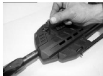
7. Remova os parafusos que ligam a parte superior e inferior da arma com uma chave allen.
