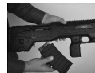
5. Se o ferrolho está para a frente, puxe a alavanca de manejo totalmente para trás, então solte-a para frente livremente. Isto irá carregar a arma de fogo.
