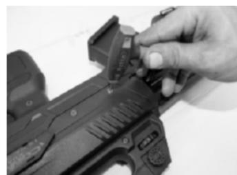
8. Você pode separar a sua arma em duas partes pressionando a parte superior e desconectando-a da base.
