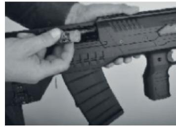
4. Inspeccione visualmente a câmara e o carregador para garantir que eles estejam descarregados. Usar seu dedo para verificar se a câmara está vazia.
