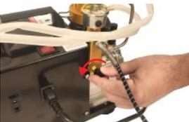
8 - Abra a válvula de expurgo girando o parafuso lateral.
