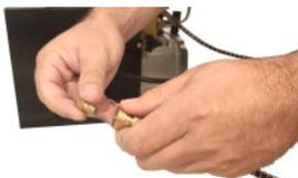
9 - Após retirar a pressão, remova o plug de teste da mangueira.
