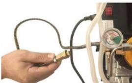
7 - Mantenha o plug de teste na ponta da mangueira para testar a pressão inicial.
