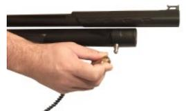
11 - Conecte o bico de engate da carabina à mangueira e insira no cilindro.
