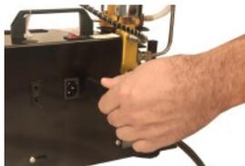
6 - Insira o cabo de energia no compressor e conecte a outra extremidade do cabo na tomada.
