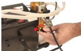
14 - Após a recarga, abra a válvula de expurgo (com compressor ligado).
