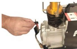
1 - Remova a tampa superior e coloque o óleo compatível indicado no manual até o nível.
