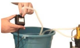
4 - Coloque a bomba submersa em um recipiente com água fria.
