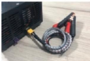
**1.** Conecte a extremidade correspondente do cabo de alimentação no compressor.
