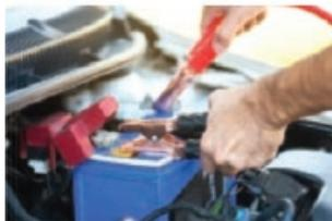
**2.** Conecte a extremidade do conector vermelho no polo positivo (+) e a extremidade do conector preto no polo negativo (-).
