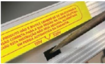
2. Com o auxílio de uma ferramenta longa, selecione a tensão correta para a sua região (110V ou 220V) na chave seletora da fonte de alimentação.
